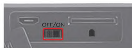
Figure 2: Location of device power switch Abbildung 2: Position des Netzschalters des Geräts Figure 2 : Emplacement de l'interrupteur d'alimentation de l'appareil Figura 2: Posizione dell'interruttore di alimentazione del dispositivo Figura 2: Ubicación del interruptor de alimentación del dispositivo
